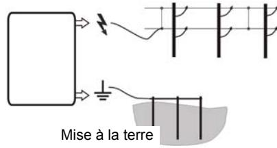
Si la fréquence des impulsions est supérieure à une fois par seconde, il faut immédiatement débrancher l'appareil et le faire contrôler.
